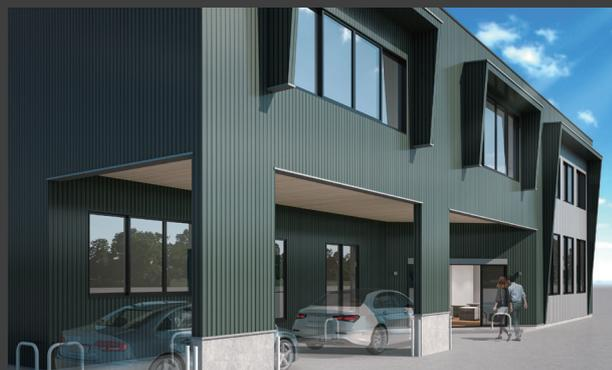
【昭和自動車学校 建築概要】 構造: 梓組壁工法(2F床、屋根はCLT) 階数: 2階建て
